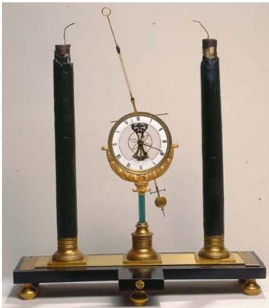
I dischi non erano posti a contatto diretto con alcuna sostanza acidula o inumidita, ma come le altre pile a secco, in realtà esisteva un elettrolita, che era il collante utilizzato tra i fogli di carta commerciale e quelli di metallo. La carta commerciale manteneva i dischi di metallo isolati dall'elettrolita che non reagiva chimicamente, cessando di deteriorare la pila.
