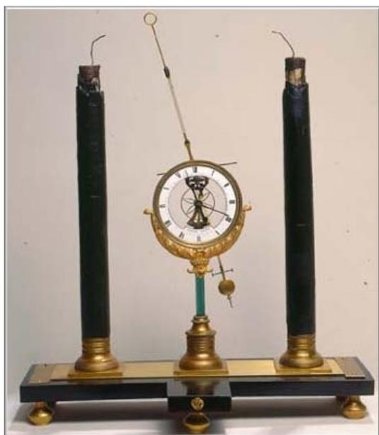
La pila rispetta la prima legge dell'effetto Volta, per la quale si sviluppa una forza elettromotrice tra metalli diversi che non dipende dall'estensione della superficie di contatto (che è molto piccola).
