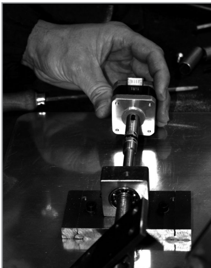
Figura 8 – Il motore passo-passo utilizzato per il moto di elevazione.
