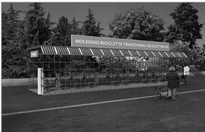
Figura 3 – Stazione di ricarica fotovoltaica per biciclette tradizionali ed elettriche inserita in un contesto urbano, ai bordi di un parco.
