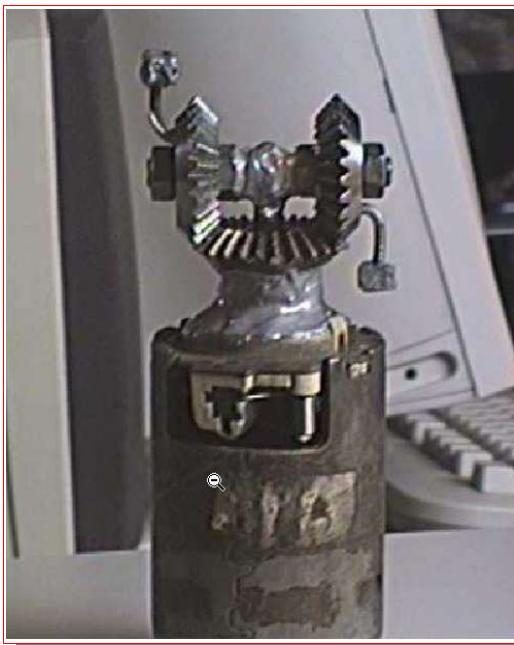
*prima volta con A a dx e B a sx e la seconda con A a sx e B a dx), sommando, così, il quell'istante, le loro forze centrifughe e producendo, quindi, in quello stesso momento il massimo della spinta in quella direzione (in avanti). E' pur vero che durante il loro percorso le masse producono forze centrifughe rivolte secondo direzioni diverse, ma a ben analizzare sempre contenute in una semisfera situata nella direzione del movimento prodotto.*
