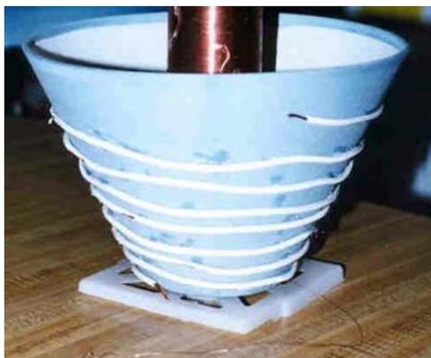
Se usa parte de una lámpara de mesa colocada al revés y se envuelve sobre ésta un alambre de cobre recubierto de plástico. Se usan 8 metros de alambre de cobre No. 12 o 14 enrollado tal como se ve en la foto.
