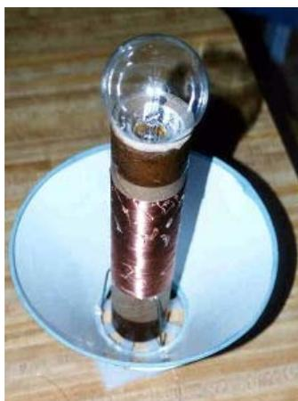
Para hacer la bobina secundaria se debe usar un tubo de plástico de PVC o incluso un tubo de cartón de 4 pulgadas de diámetro con 1 metro de longitud, alambre esmaltado No #22, #24 o #26. Deben enrollarse unas 200 espiras del alambre esmaltado en el tubo, dejando unos 5 cm en cada extremo del tubo.
